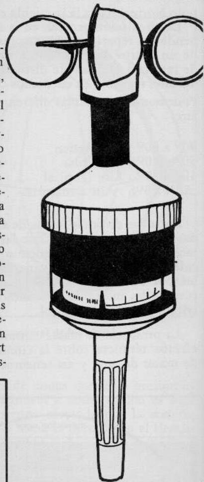
Fig. 2. Anemómetro de cazoletas con lectura instantánea de la velocidad.
